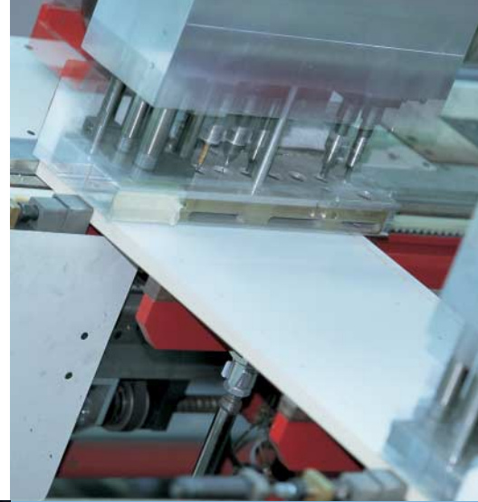
EtherCAT-Technologie im Einsatz in einer Klein- und Schmalteile-Bohranlage und einer Frontenbohrstraße einer Schubkasten-Fertigungslinie bei Nobilia.
