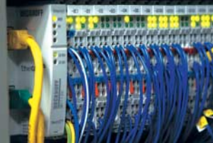
EtherCAT-Technologie im Einsatz in einer Klein- und Schmalteile-Bohranlage und einer Frontenbohrstraße einer Schubkasten-Fertigungslinie bei Nobilia.
