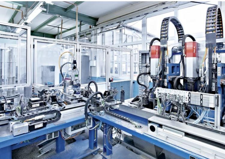
Die von Aumat und AST konzipierte, verkettete Schlüssel-Fertigungsstraße, bestehend aus einer Einschneid- und einer Längsprofilfräsmaschine, bearbeitet Schlüsselrohlinge hochpräzise und bis hin zu Losgröße 1.
