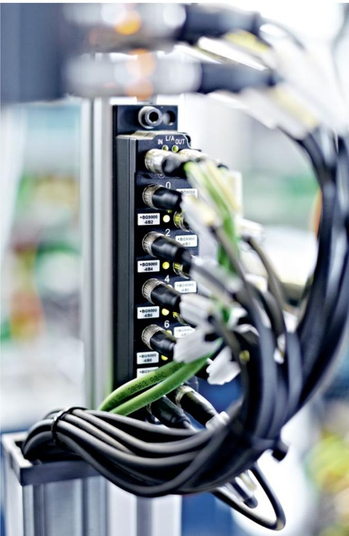
Die dezentrale Erfassung der I/O-Daten über die EtherCAT-Box-Module EP1008 und EP2028 direkt vor Ort im Prozess reduziert den Schaltschrankplatzbedarf auf ein Minimum.
