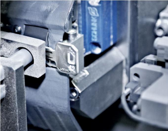
Die Schlüsselrohlinge erhalten auftragsbezogen zunächst das gewünschte Längsprofil und anschließend die Einkerbungen des Schlüsselbarts.
