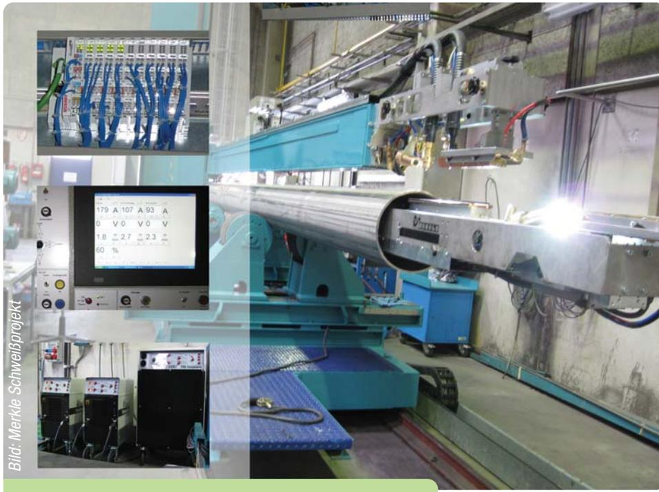
Bild 1: Hier sind neue Entwicklungen gefragt: Bei einem Projekt, bei dem gebogene Bleche zu Rohren verschweißt werden, kommt eine Ethercat-Master-Lösung zum Einsatz.
