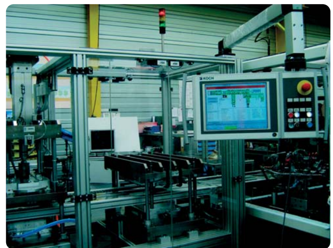
Bild 4: Gesamtübersicht der Anlage am Industrie-PC – Mit der Entscheidung Ethercat einzuführen, konnte Koch Pac-Systeme im Vergleich zur bisherigen Feldbuslösung die Geschwindigkeit der Anlage um den Faktor 8 steigern.
