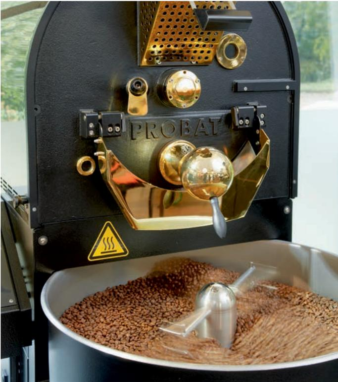
Um Kaffeeröstungen in reproduzierbarer und gleichbleibender Qualität herzustellen, bedarf es einer Rezeptverwaltung, mit der vorhandene Rezepte abgefahren und neu erstellt und gespeichert werden können. Gleichzeitig müssen Messkurven visualisiert werden, um den Röstvorgang zu kontrollieren und zu protokollieren.
