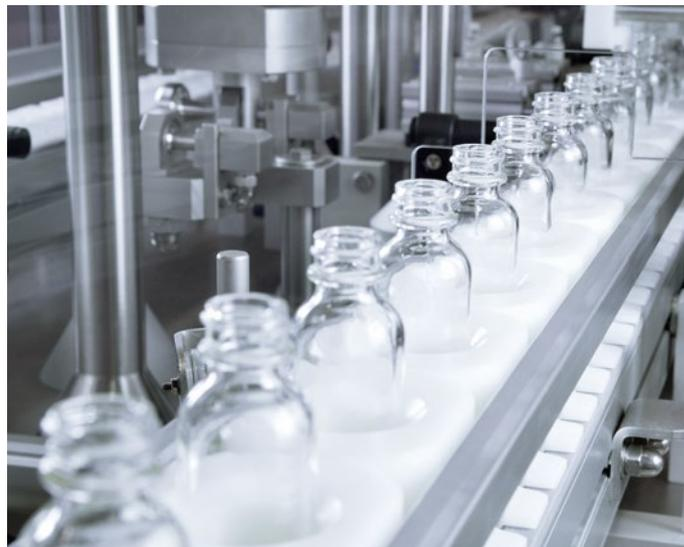
Das Transfersystem der lite-F-Maschine ist als Förder-Loop für den Betrieb mit und ohne Pucks sowie mit einem Wechsel-Gate konzipiert, das auf vielfältige Behältergrößen angepasst werden kann.
