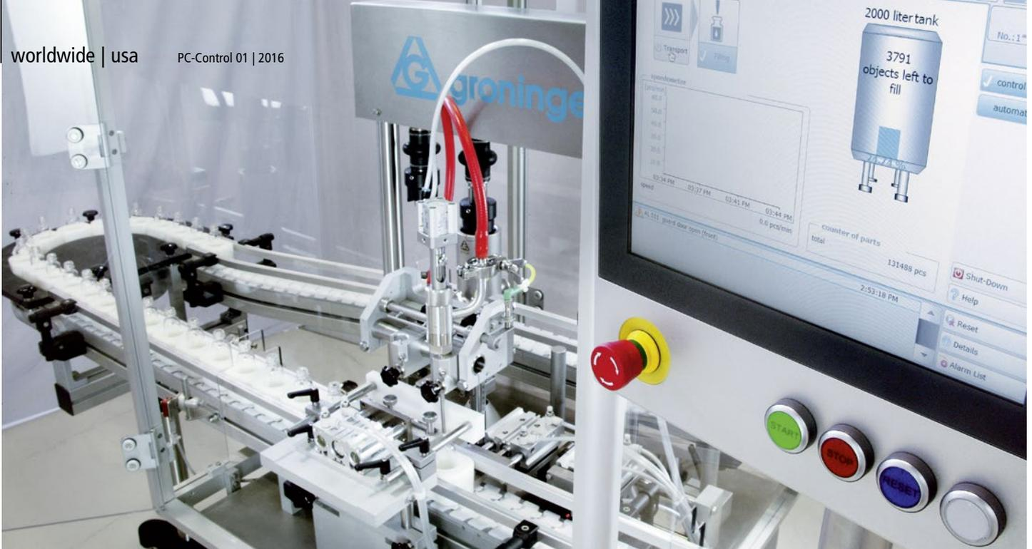
Das Füllsystem der lite-F-Maschine verwendet die bewährten groninger-Verdrängerpumpen zur hochgenauen Abfüllung.
