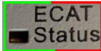
Wenn ein Slave sich nicht im zuletzt vom Master angeforderten Zustand befindet, wird ein Fehler im **AL Status**-Register und ein entsprechender Fehlercode im **AL Status Code**-Register 0x0134 gemeldet: Der AL Status Code kann vom Master ausgelesen werden und bietet die Diagnoseinfo der ESM, um die Info der Error-LED zu vervollständigen (falls diese LEDs unterstützt sind).
