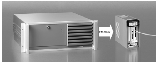
Bild 7: EtherCAT führt zu kleineren Steuerungen
