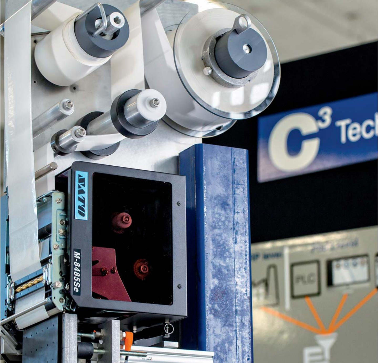
Das Smart Identity System von C<sup>3</sup> bietet optimale Konnektivität: Anwender können per Fernzugriff – von jedem webfähigen Gerät aus – Befehle anstoßen, zuverlässige Diagnostik implementieren, Vorlagen und Etiketten flexibel ändern und auf Daten zugreifen.
