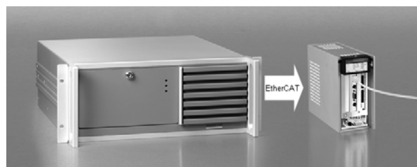
Bild 7: EtherCAT führt zu kleineren Steuerungen
