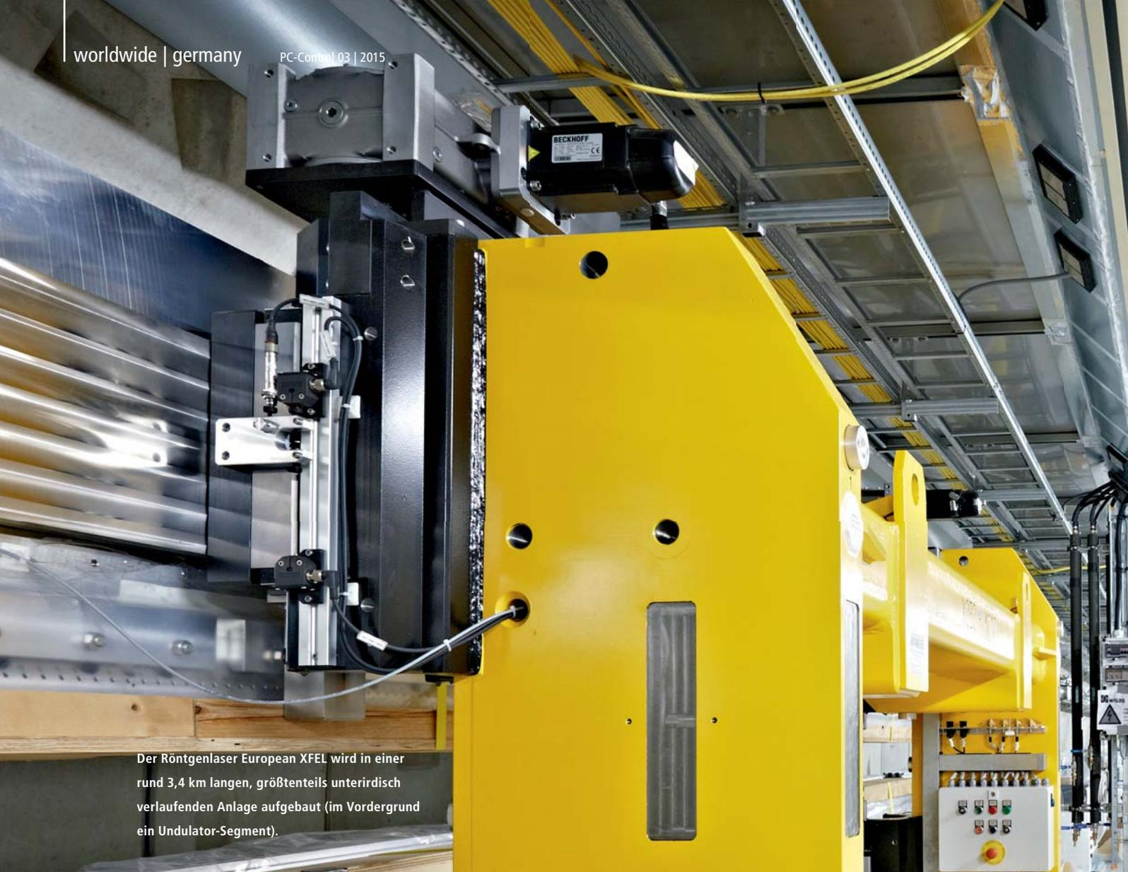
Der Röntgenlaser European XFEL wird in einer rund 3,4 km langen, größtenteils unterirdisch verlaufenden Anlage aufgebaut (im Vordergrund ein Undulator-Segment).
