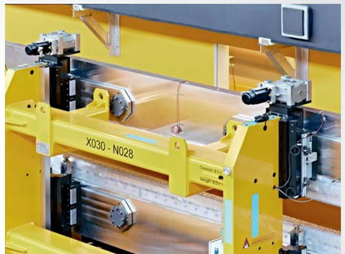
Insgesamt vier Servomotoren AM3052 je Undulatorzelle sorgen – gesteuert per TwinCAT NC PTP – für präzise positionierte Magnetstrukturen (hier die beiden Motoren der oberen Magnetstruktur).
