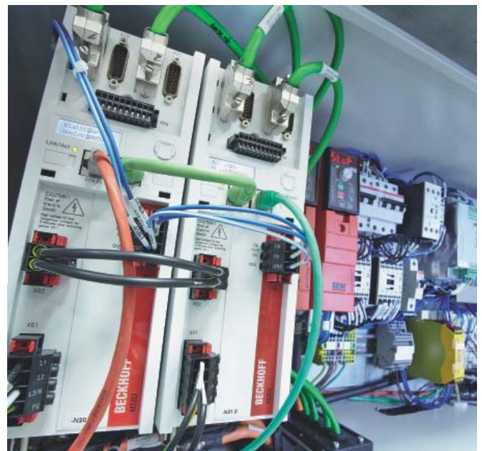
控制柜内部图。图中，EtherCAT AX5000 伺服驱动和 EtherCAT 终端用于对 Delta 机器人进行可靠的动态控制。
