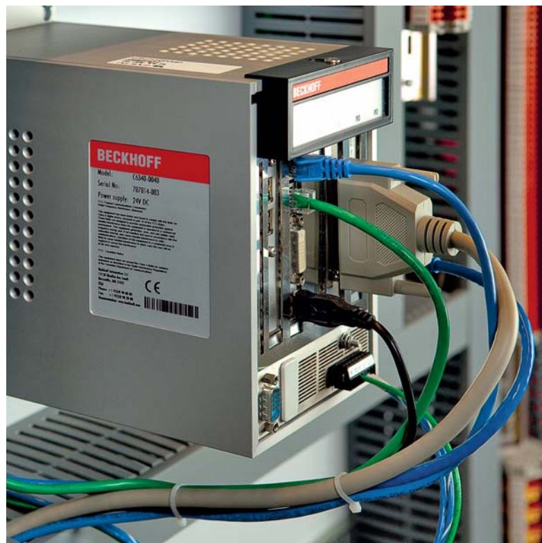
Rückgrat des Steuerungssystems ist ein Beckhoff Industrie-PC C6340, ausgestattet mit einem Intel®-Pentium®-M-1.8-GHz-Prozessor.
