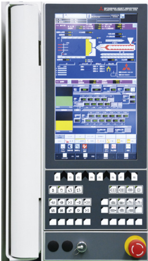
Die Steuerung der MEIII besteht aus einem Panel-PC CP6216.
