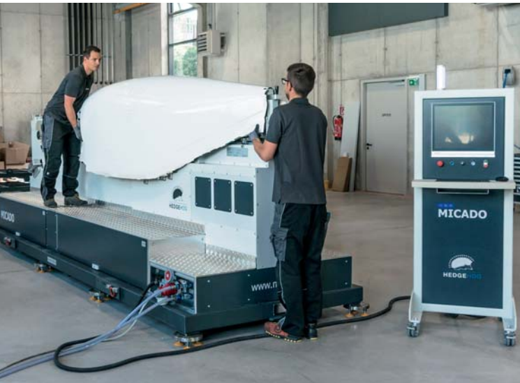
Aufspannen eines Flugzeugbauteils auf den Hedgehog
